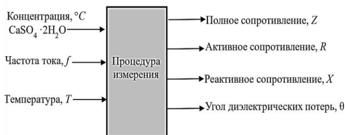
Рис. 1. Эмпирическая модель эксперимента / Fig. 1. Empirical model of the experiment
