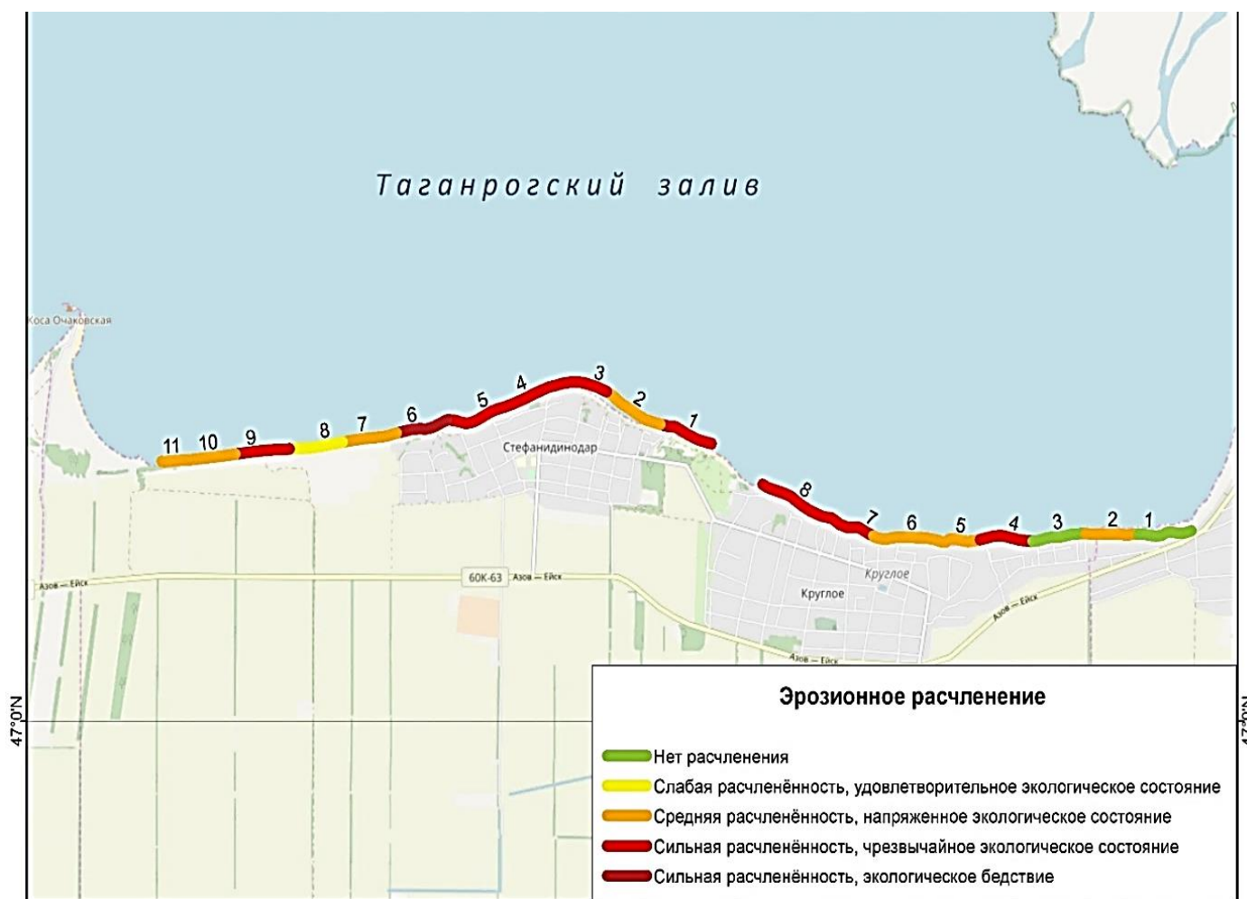
Рис. 5. Степень эрозионной расчлененности для полигонов 1 и 2 на погонный километр / Fig. 5. The degree of erosion dismemberment for polygons 1 and 2 per linear kilometer
